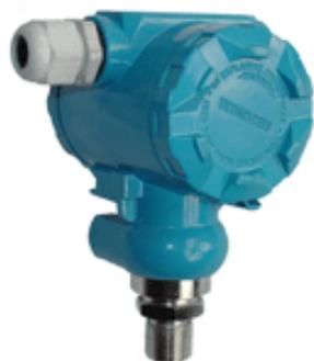
**BP800、801 系列压力变送器**具有工作可靠、性能稳定、安装使用方便、体积小、重量轻、性能价格比高等点，能在各种正负压力测量中得到广泛应用。采用进口扩散硅或陶瓷芯体作为压力检测元件，传感器信号经高性能电子放大器转换成 0-10mA 或 4-20mA 统一输出信号。可替代传统的远传变送器，霍尔元件、差动变送器，并具有 DDZ- II 及 DDZ-III 型变送器性能。能与各种型号的动圈式指示仪、数字变送器、电子电位差计配套使用，也能与各种自动调节系统或计算机系统配套使用。
